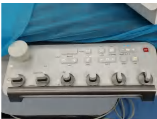
设备自带紧急止动开关（DSA 手术台）
